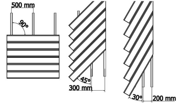
La distance entre lambourdes doit être de maximum 500mm. Lors d'un montage sous un angle, l'écart entre les lambourdes doit être respecté.
