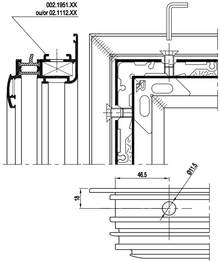
Assemblages par équerres à téton ou à sertir
