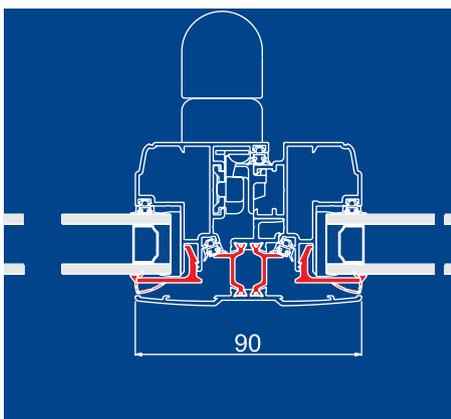
Le concept de "l'OUVRANT CACHE" permet d'obtenir une isolation thermique performante, une triple barrière de joints et l'augmentation du gain de luminosité, + 20%. D'une grande finesse des lignes, XS 50 répond à toutes les applications et fabrications quelques soient la conception.
